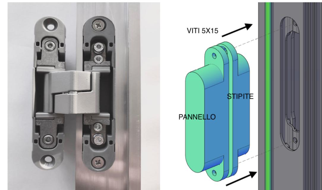
**FASE 7** : FARE LA STESSA OPERAZIONE CON L'ANTA, UTILIZZANDO LE 4 VITI TPS 5X20; A QUESTO PUNTO PROCEDERE SE NECESSARIO CON LE REGOLAZIONI DEL CASO SEGUENDO LE INDICAZIONI PRESENTI NELLA FIGURA CHE SEGUE; LE CERNIERE SONO REGOLABILI **VERTICALMENTE** AGENDO SULLE VITI 1 (si alza e si abbassa l'anta), **ORIZZONTALMENTE** AGENDO SULLE VITI 2 (si avvicina o sia allontana l'anta all'incontro), IN **PROFONDITA'** AGENDO SULLE VITI 3 (si schiaccia più o meno l'anta alla guarnizione).
