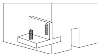
pinna (direzionale) da applicare nella parte inferiore del pannello ove e' presente l'apposita fresata applicare con avvitamento a pavimento
