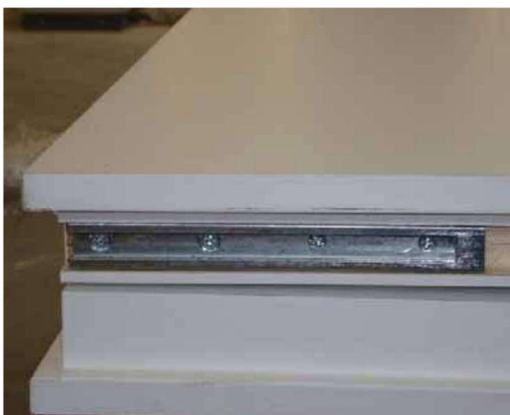
riposizionare nella parte superiore il braccetto precedentemente smontato e riposizionarlo nella stessa posizione di fabbrica, questo serve a mantenere in guida il pannello nella sua normale movimenione e funzionalità.
