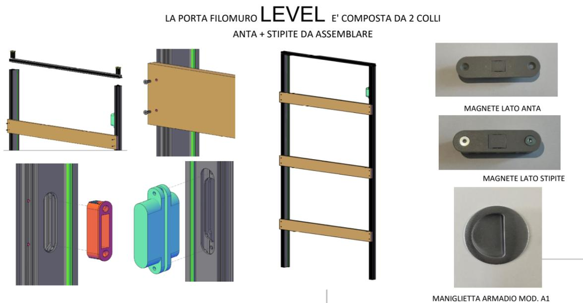
IN OGNI PORTA SONO INSERITE LE ISTRUZIONI TECNICHE DI MONTAGGIO E REGOLAZIONE LA SCATOLINA ACCESSORI E' ALL'INTERNO DELLO STIPITE FILOMURO LEVEL
