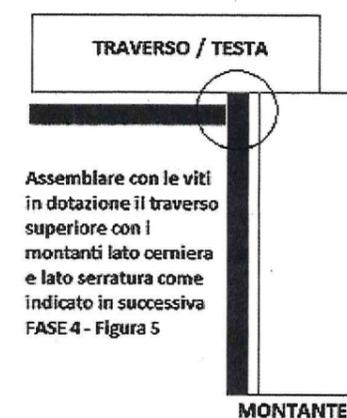
Assemblare con le viti in dotazione il traverso superiore con i montanti lato cerniera e lato serratura come indicato in successiva FASE4 - Figura 5
