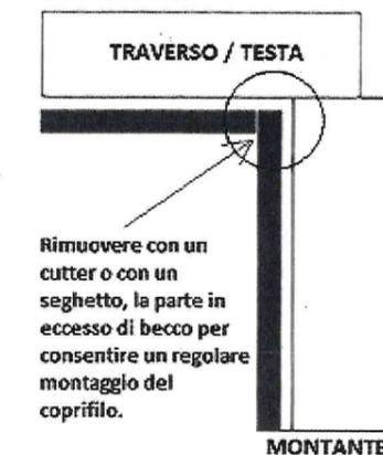
Rimuovere con un cutter o con un seghetto, la parte in eccesso di becco per consentire un regolare montaggio del coprifilo.
