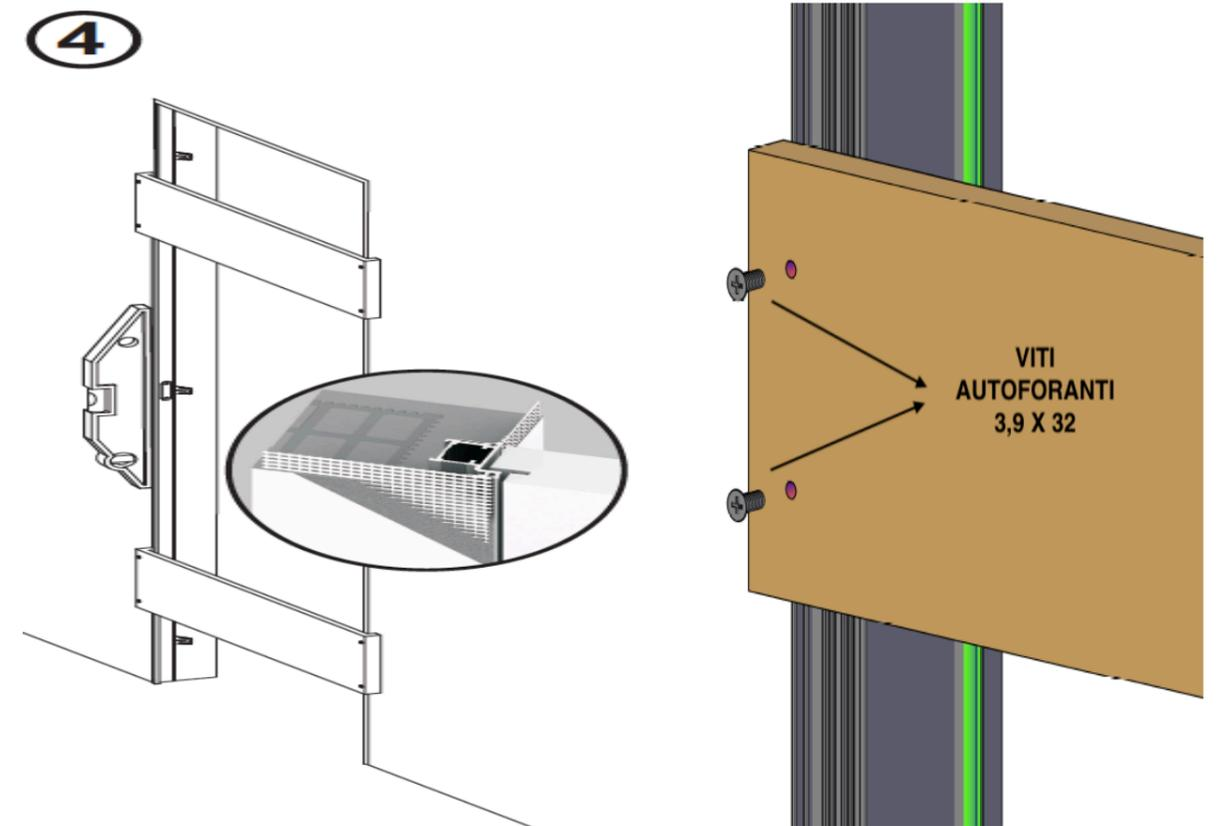
**FASE 5 : MONTARE LE 8 ZANCHE IN DOTAZIONE UTILIZZANDO LE VITI AUTOFORANTI TC 3,9X16 NELLA POSIZIONE UTILE A SECONDA CHE LA PORTA DEBBA ESSERE MONTATA FILOMURO LATO ESTERNO O LATO INTERNO E A SECONDA CHE L'APPLICAZIONE SIA SU MURATURA O CARTONGESSO**
