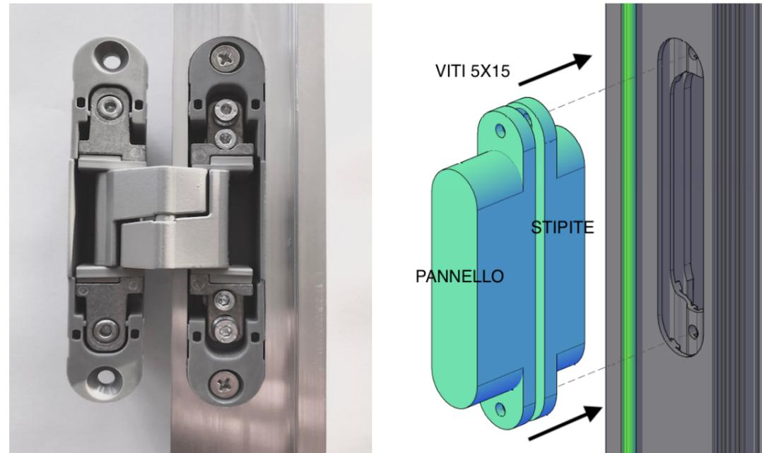
**FASE 7** : FARE LA STESSA OPERAZIONE CON L'ANTA, UTILIZZANDO LE 4 VITI TPS 5X20; A QUESTO PUNTO PROCEDERE SE NECESSARIO CON LE REGOLAZIONI DEL CASO SEGUENDO LE INDICAZIONI PRESENTI NELLA FIGURA CHE SEGUE; LE CERNIERE SONO REGOLABILI **VERTICALMENTE** AGENDO SULLE VITI 1 (si alza e si abbassa l'anta), **ORIZZONTALMENTE** AGENDO SULLE VITI 2 (si avvicina o sia allontana l'anta all'incontro), IN **PROFONDITA'** AGENDO SULLE VITI 3 (si schiaccia più o meno l'anta alla guarnizione).
