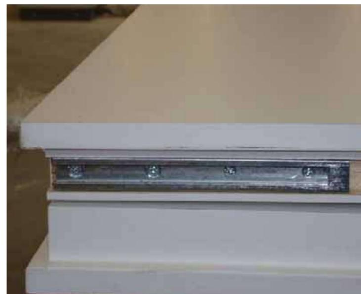
riposizionare nella parte superiore il braccetto precedentemente smontato e riposizionarlo nella stessa posizione di fabbrica, questo serve a mantenere in guida il pannello nella sua normale movimentione e funzionalità.
